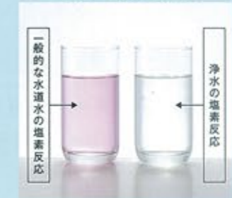
▶DPD試薬による残留塩素測定
